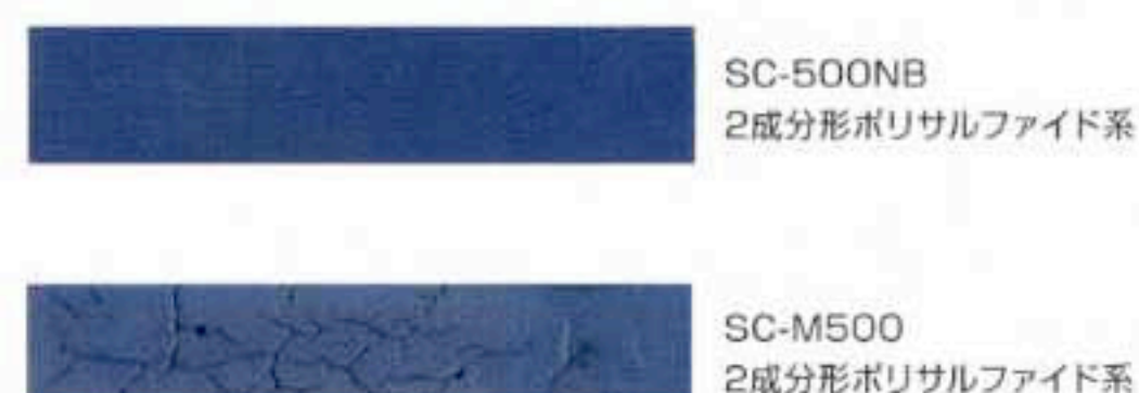
〈サンシャインウェザーオメーター3,000時間照射後状況〉
